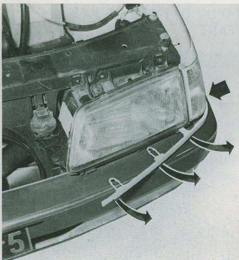
Dégager la baguette inférieure d'optique de phare en la tirant vers l'avant
