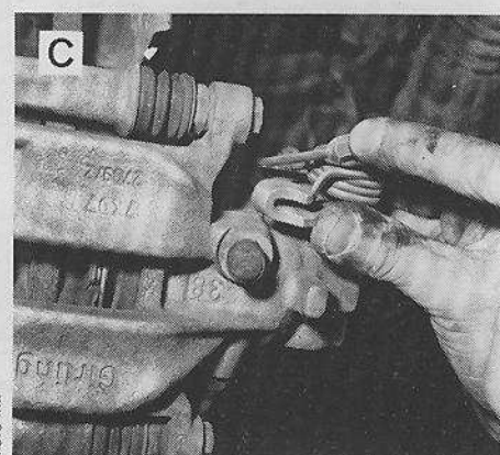
Remplacement des plaquettes de frein arrière A. Desserrage de la colonnette - B. Dépose des plaquettes - C. Décrochage du câble de frein à main.
